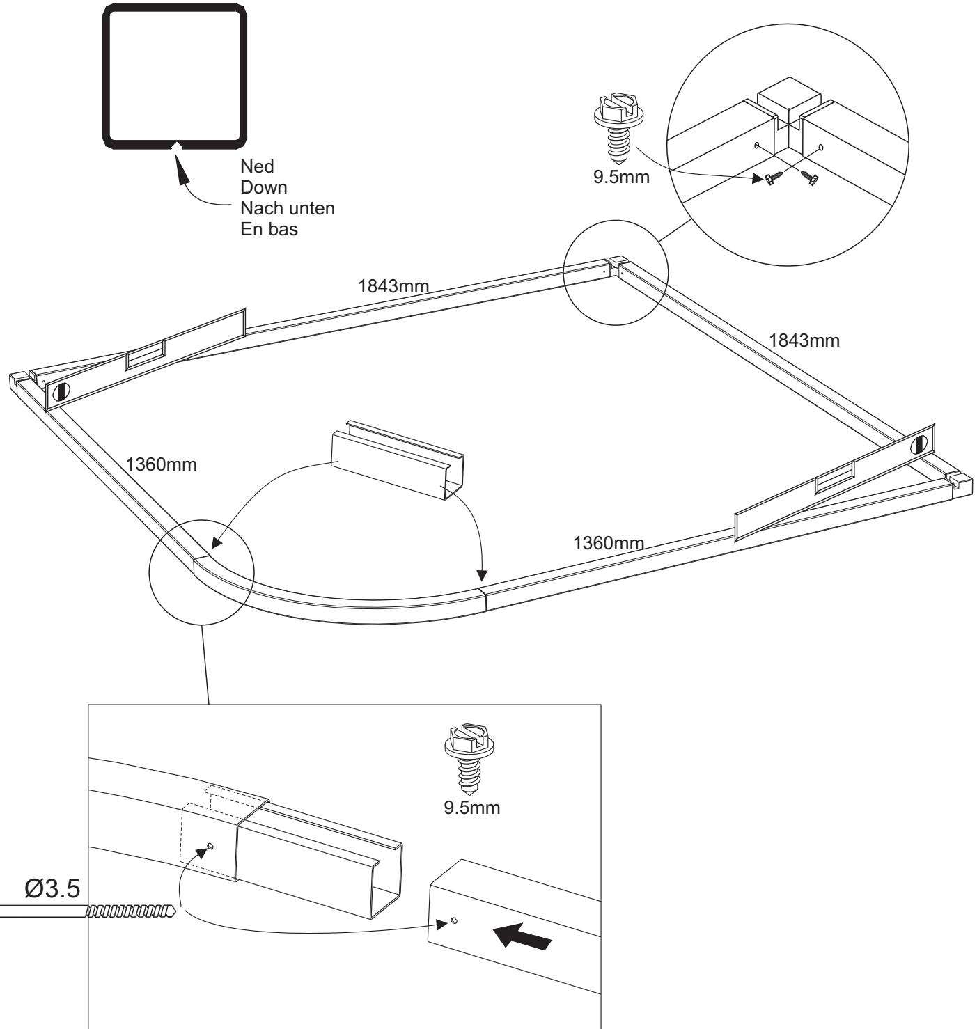
Lägg ut golvramarna. Kontrollera att ramen ligger plant, använd vattenpass. Är ramen inte plan, justera genom att palla upp på nödvändiga ställen under golvramen. OBS! Det är ett absolut krav att golvramen ligger plant "i väg" för att slutresultatet skall bli perfekt.
